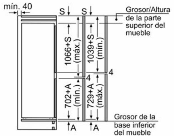
Las dimensiones dadas de la puerta del mueble corresponden a una junta de puerta de 4 mm.
