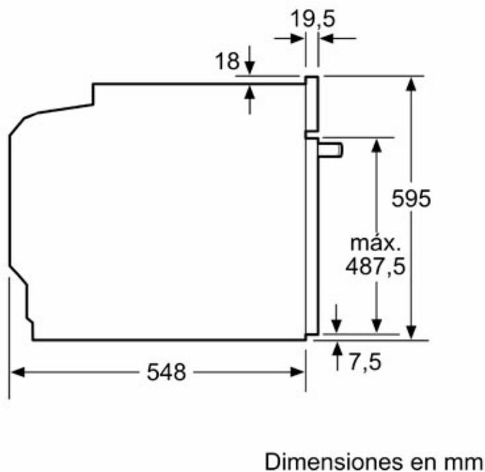
Si se instala el aparato debajo de una placa, se debe respetar el siguiente grosor de encimera (incl., dado el caso, la estructura de soporte).
