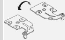
24. Retire la tapa del orificio del tornillo (1) en la parte superior izquierda y colóquela en el lado derecho (2).
