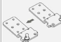
15. Fije la bisagra izquierda (1) con los tornillos (4) y atornille la pata (3).
